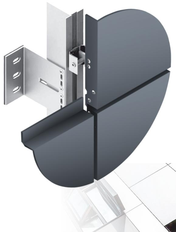
Вентильований фасад монтується до стіни так, щоб між стіною і декоративним покриттям був повітряний зазор через який видаляється внутрішня волога. Також завдяки йому зберігається тепло в приміщенні та підвищується звукоізоляція. З метою додаткового утеплення, як правило, між стіною та облицювальним матеріалом встановлюють термоізоляційний шар.
